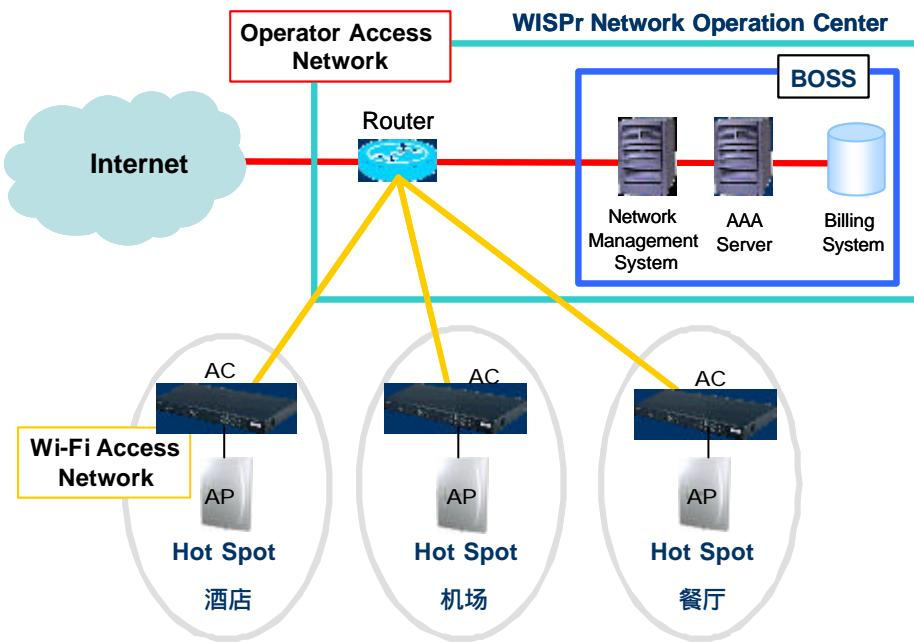
其中，计费认证系统采用 GSI B4000 系统，方案支持 WEB、802.1x 和 MAC 认证方式，网管系统采用 S6000 网管系统，最大限度地协助 WISP 管理好自己的网络。
